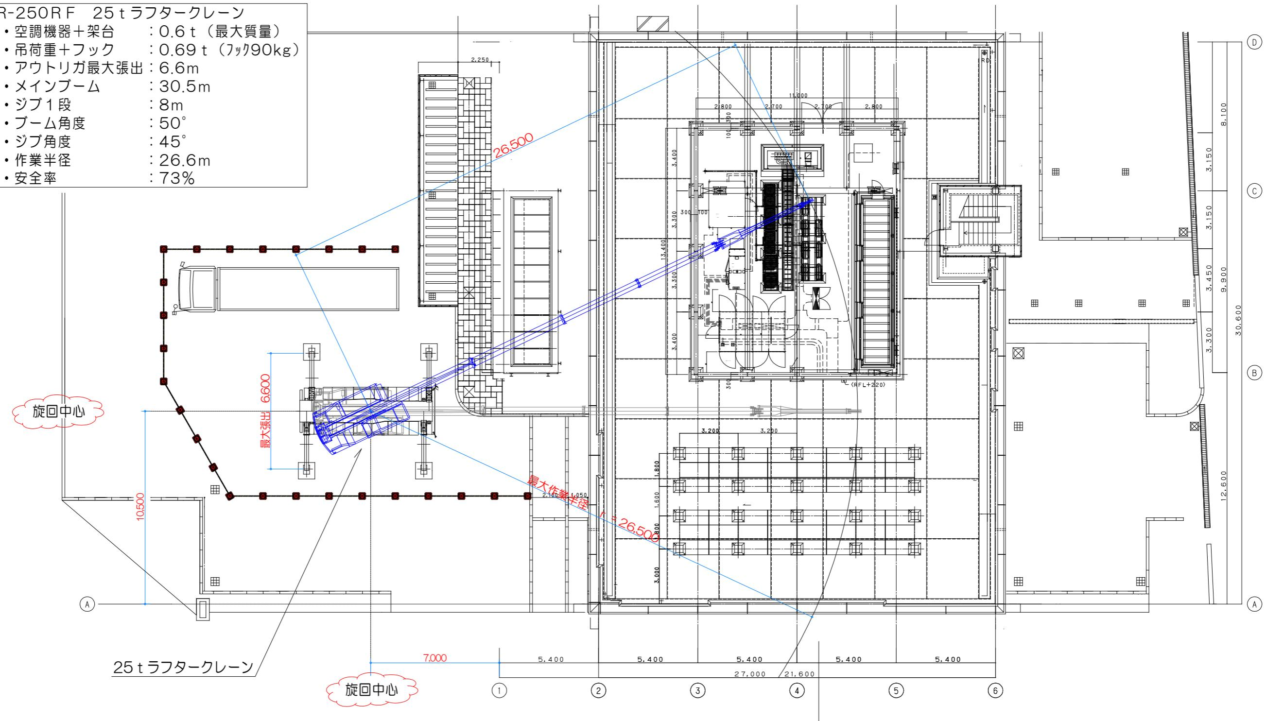
※25t ラフターカークレーン設置場所（旋回中心） ①通り西へ7m A通り北へ10.5m
